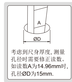
楔形塞尺测量孔径
